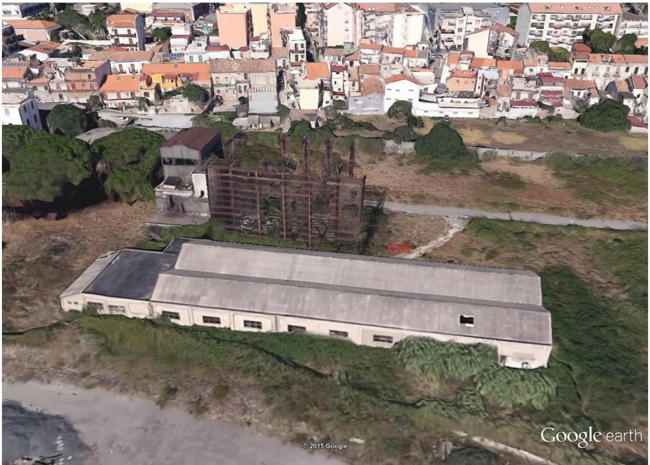
Dell'edificio U16 verrà dismessa la copertura a falde del padiglione di stoccaggio fusti e quella dello spogliatoio annesso, in quanto la copertura della sala motori è una normale copertura a terrazzo bitumata.
